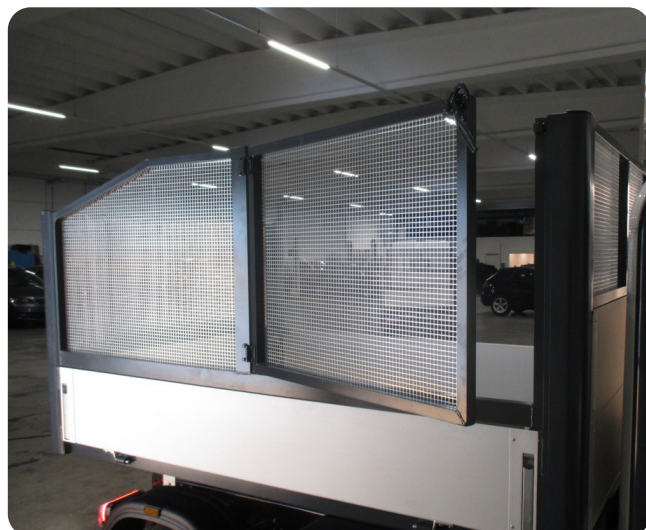
Gitterkonstruktion med mulighed for sidedør
