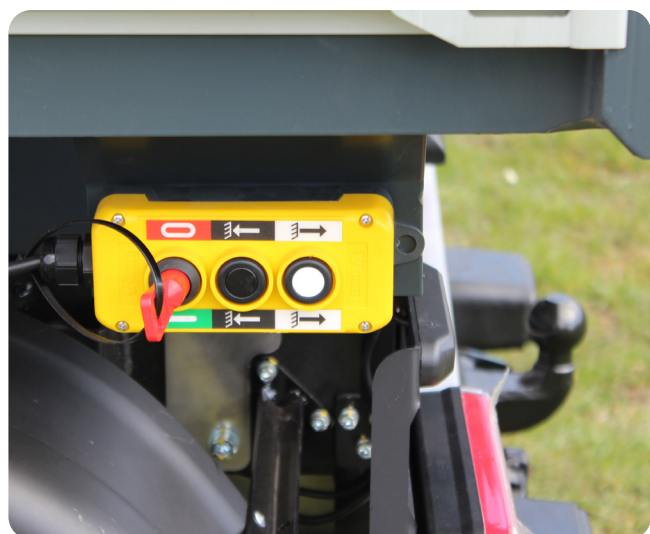
Betjeningspanel til hydraulisk tiplad, inkl. nøgle
