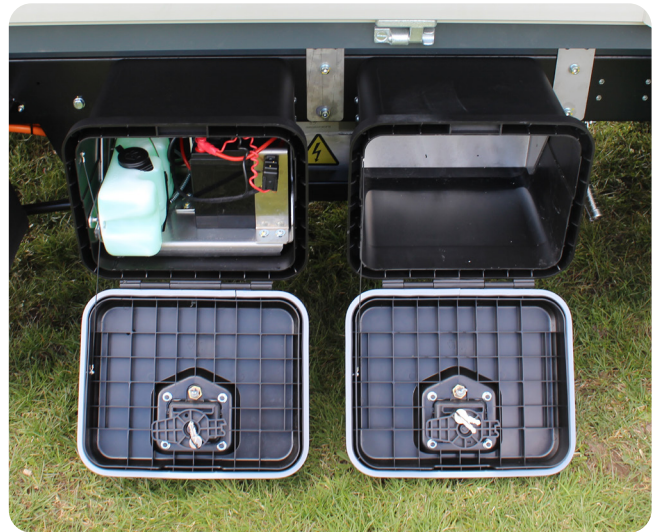
Venstre boks: vandtank til vinduesvask, samt 12 V batteri til brug af lys, varme i forrude m.m. Højre boks: værktøjskasse (tilbehør)
