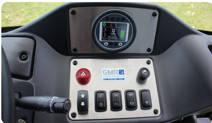
Instrumentbræt med betjeningspaneler: Kontakt for frem/tilbage-kørsel, kontakt til advarselslys, kontakt til dørlås, 2-trins-kontakt for hurtig / langsom kørsel, hill start assist, vinduesvisker til / fra, sprinklervæske og cigarettænder
