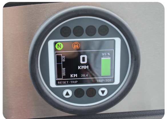
Kontroldisplay med kilometervisning, driftstimetæller, visning af batteriopladning og eventuelle fejlkoder.
