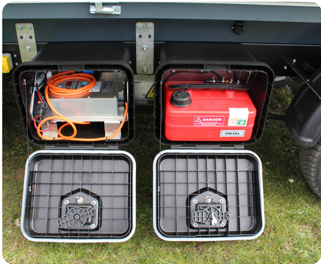
Venstre boks: Oplader med 220 V stik. Højre boks: Dieseltank til Webasto opvarmning
