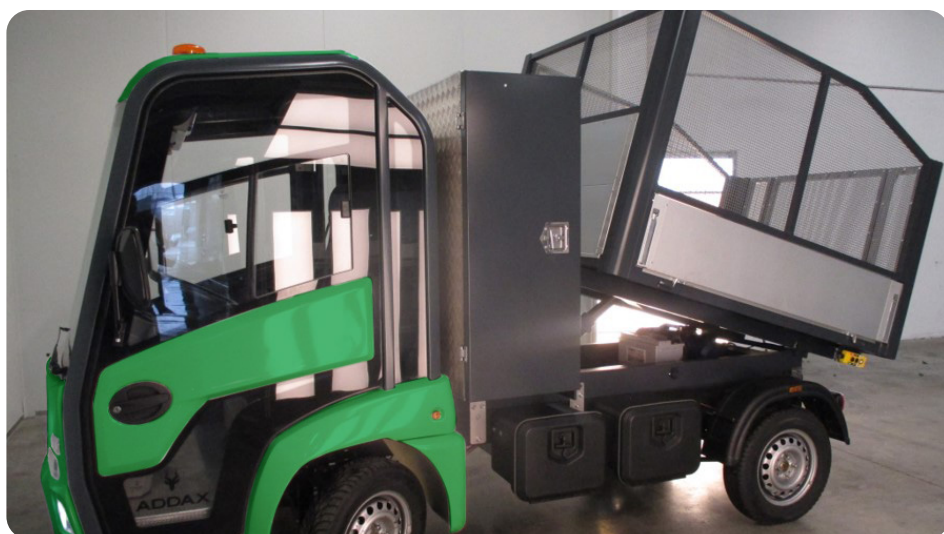
Kort tiplad med opklappelige ladsider, samt aluminiums værktøjskasse
