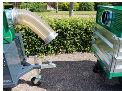
Enkel tilkobling af sulky og 8" afgangsslange
