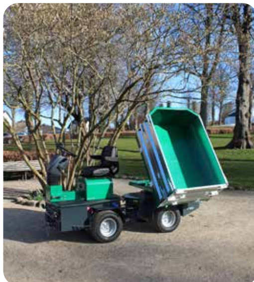
Hydraulisk tiplad med hydraulisk sving
