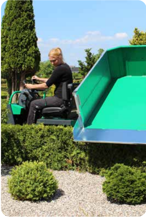
Hydraulisk tiplad med 180° sving
